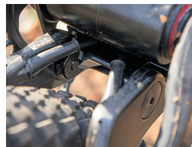
Oben: Bike-Ahead-Carbon-Felgen mit 28 Millimetern Maulweite sorgen für ein großes Reifenvolumen. Der Laufradsatz bringt dabei nur 1390 Gramm auf die Waage. Unten: Die Leitungen verlaufen ohne große Biegungen in die Kettenstreben.
